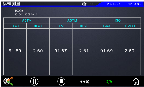
图26 标样连续测量中
