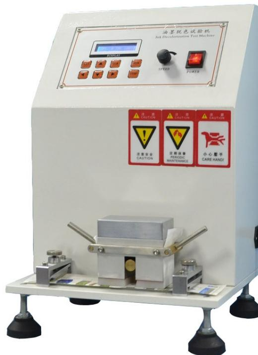
图 1 油墨印刷耐磨试验仪（图片仅供参考，以实物为准）
