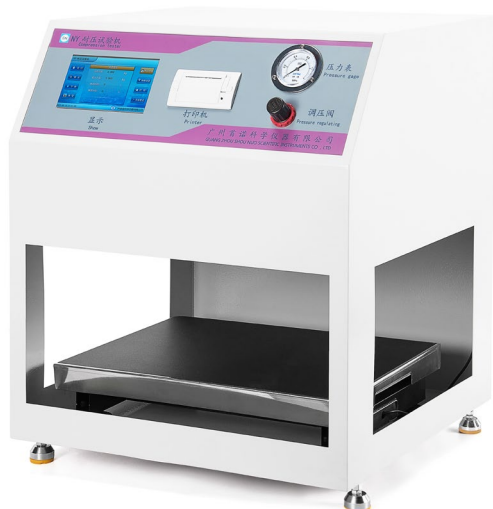
图1 NY-01 耐压试验仪（图片仅供参考，以实物为准）
