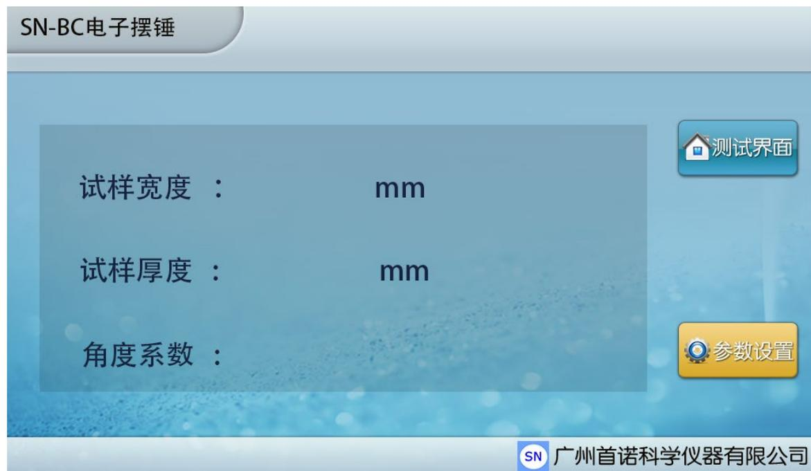
如图所示。正确输入试样的宽度和试样的的厚度。如角度有较大误差，返回测试界面，使摆锤自然垂直后，点击“清零”，点击“复位”，把摆锤置于最左端，使其吸合。利用下列公式计算出角度系数，点击“角度系数值”，修改即可
